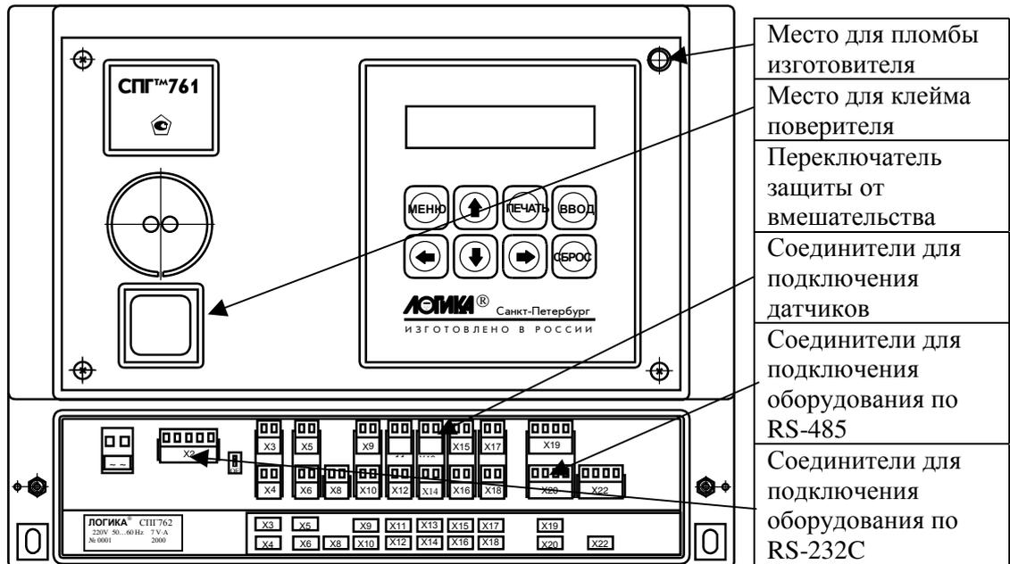
Рисунок 6.1 - Вид на СПГ761 при откинутой крышке монтажного отсека
