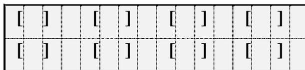
Последовательно нажимают на каждую клавишу клавиатуры в последовательности: слева - направо и сверху – вниз. Наблюдают каждый раз сообщение на табло. На табло поочередно в каждом из соответствующих окон кратковременно должна появляться темная вертикальная полоса, например, как показано ниже, для клавиши **СБРОС**:
